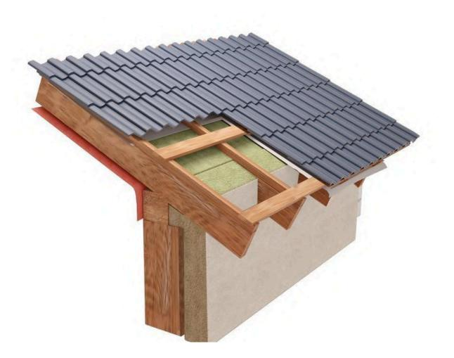
Las vigas forman el armazón principal de la cubierta de la casa, con una separación estándar de 60 cm entre cada una.
